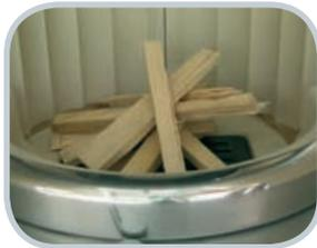
4. Gespaltenes Kleinholz (aus Weichholz) gemäß Abbildung in der Mitte des Brennraumes aufschichten.
